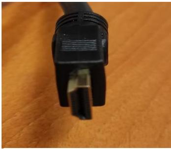
Clavija del cable HDMI
